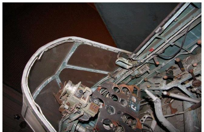
写真11・12 ガーバー保存施設内で撮影された「流星」機体と「第1固定風防と計器盤」 長島宏行氏提供
