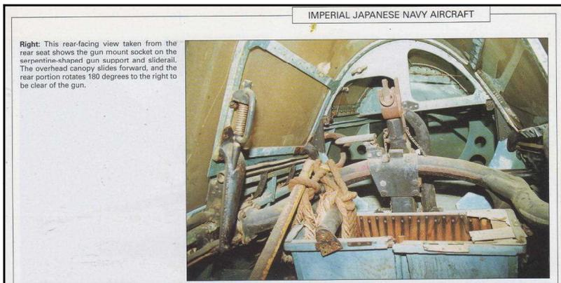
図5 ガーバー施設内の「流星」後部席と第3可動風防、回転式の第4可動風防
