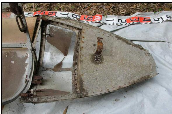
写真16 第4可動風防の裏側、機銃固定用金具
