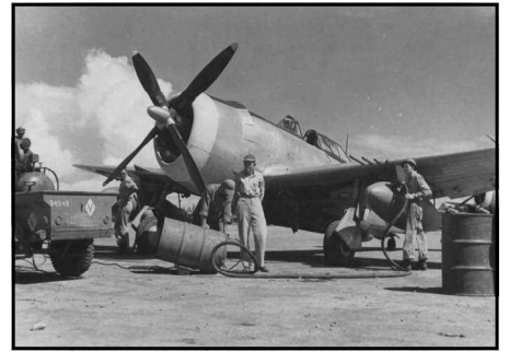
写真6 第7航空軍第318戦闘機群団第73戦隊のP47D戦闘爆撃機翼下に165ガロン増設燃料タンクへのナパーム増粘したガソリン注入の様子 工藤洋三氏提供
