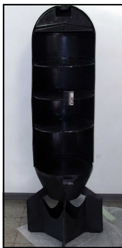
写真17 朝鮮戦争時（1950年）でのM16 M1クラスターアダプターへの伝単格納の様子 パブリックドメイン
