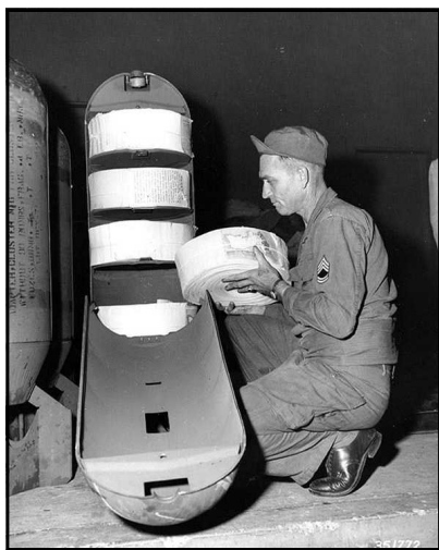
写真17 朝鮮戦争時（1950年）でのM16 M1クラスターアダプターへの伝単格納の様子 パブリックドメイン
