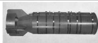
▲ E46 (M19) 集束焼夷弾の集束 (左) と外観 (右) M69 焼夷弾を19発ずつ2段で合計38発集束している。【米国立公文書館】
