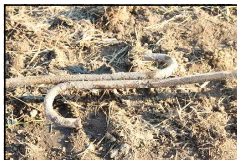
㉖玉名飛行場第2大型格納庫基礎部の三次元計測図 玉名市教育委員会提供 ㉗解体された同格納庫北西部コーナー部 ㉘フーチング内部の鉄筋ボルト部材 ㉙U字型鉄筋部材
