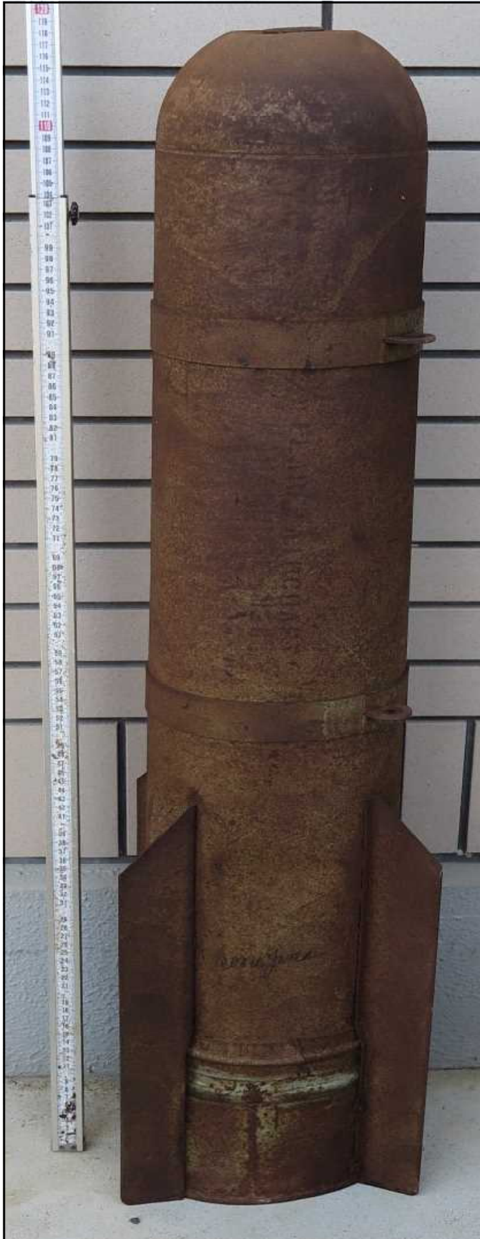
写真4：左 M26 照明弾全景 胴部中央の横書き三段で「FLARE, AIRCRAFT, PARACHUTE, M26 LOT ○○○○」銘 最下段に「Komiya」銘 写真5：右上 頭部の拡大状況、信管部 の開口状況 写真6：右下 尾翅部の拡大状況、外面 色の灰色と錆びの状況
