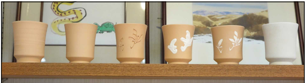
高田焼（八代焼）における象眼技法の工程
